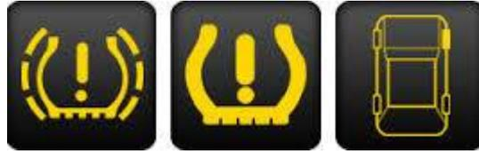
Seit 1. November 2014 müssen gemäß neuer EU-Richtlinie alle neu zugelassenen PKW mit Reifendruckkontrollsystemen (RDKS/TPMS) ausgerüstet sein. Es gibt **indirekt** messende Systeme, die möglichen Luftverlust über die Raddrehzahl (z.B. ABS-Steuergerät) ermitteln. Bei der Reifenmontage werden normale Ventile verwendet, weshalb hier dem Kunden **keine zusätzlichen Kosten** entstehen.
